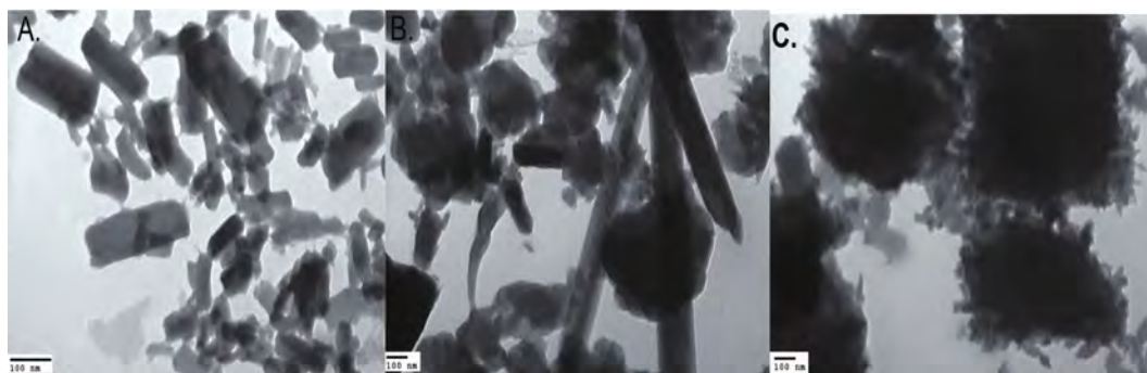
图 4 纳米 \text{CoC}_2\text{O}_4 (A), PAN- \text{CoC}_2\text{O}_4 纳米复合物(B)及固定 Lac 的 PAN- \text{CoC}_2\text{O}_4 纳米复合物(C)的 TEM 照片
